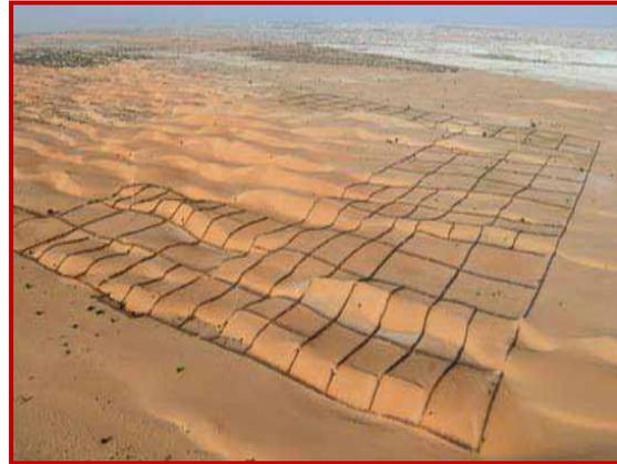
Photo 6 : vue générale d'une zone stabilisée mécaniquement :(AHMED, 2010 *in* MED)
