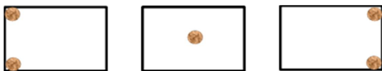
Figure 8 : Schéma de prélèvement des échantillons de sol sur chaque bloc
