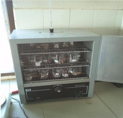
**Photo 10** : Séchage des échantillons à l'étuve à 75°C pendant 72 heures
