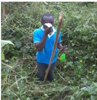
**Photo 4:** Mesure de l'azimut pour définir une direction lors de l'installation d'une placette
