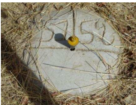
Photo 6 : le fil à plomb est aligné sur le trou central du bornage
