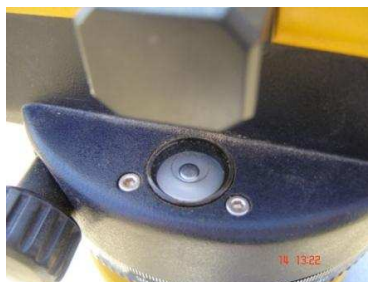
Photo 7 : mise à niveau du viseur
