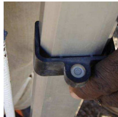
Photo 5 : niveau circulaire au dos de la mire
