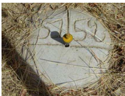
Pour un périmètre : le plomb est centré sur le trou central du bornage (photo 3).
