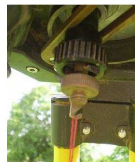
Photo 2 : Le crochet du fil à plomb
