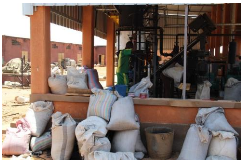
Balles de riz utilisées comme combustible pour la production d'énergie
